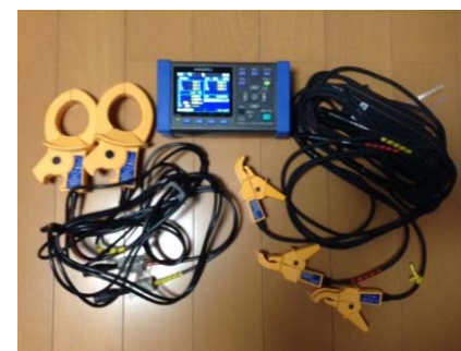
データロガー機能付 電力計測器
