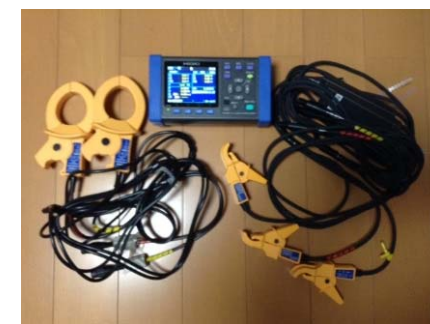
データロガー機能付 電力計測器
