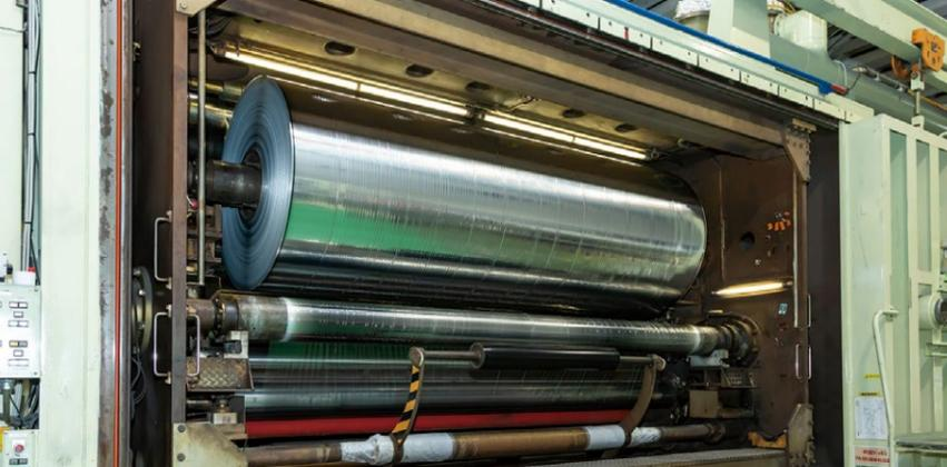
3m 幅連続真空蒸着装置
