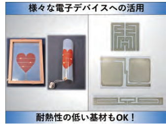
様々な電子デバイスへの活用 耐熱性の低い基材もOK！ LED実装及びRFIDアンテナへの活用例。多彩なカスタマイズが可能。
