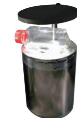
インキュベータ内に設置し細胞の成長を画像記録する装置
