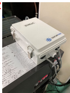
オイルコンの上に設置したSiMoC子機 (ソシアテック製)
